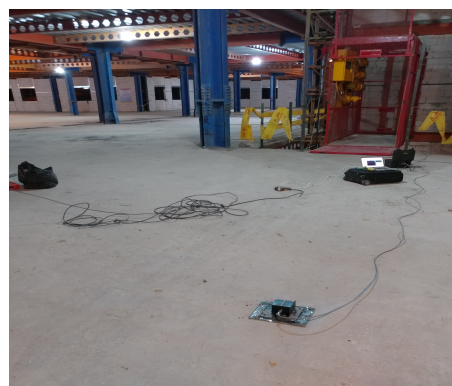
شکل ۷.۵: ۷.۵ (آ) تجهیزات تست ارتعاش محیطی، ۷.۵ (ب) سنسور تک محوره
